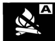
Символи класів пожеж, для гасіння яких вогнегасник непридатний, перекреслюються червоною діагональною лінією від верхнього лівого кута до нижнього правого кута використовуваного символу.
